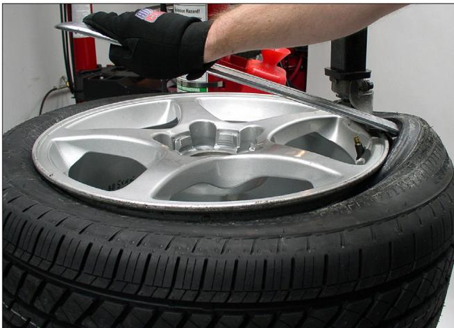
Figure 11 – Soulever le talon par-dessus l'outil de démontage
