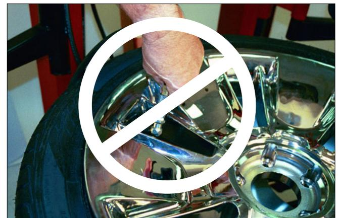
Figure 28 – Ne pas utiliser un mandrin d'air de style portatif
