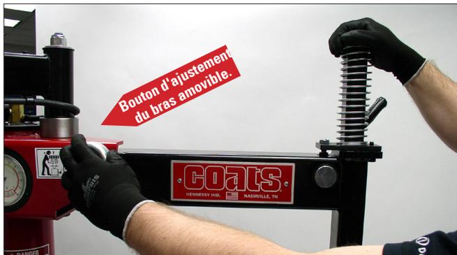
Figure 8 – Régler le bras mobile pour positionner le galet de tête
