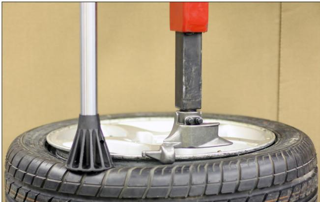
Figure 14 – Robo-Arm LR pour exercer une pression sur la paroi latérale du pneu
