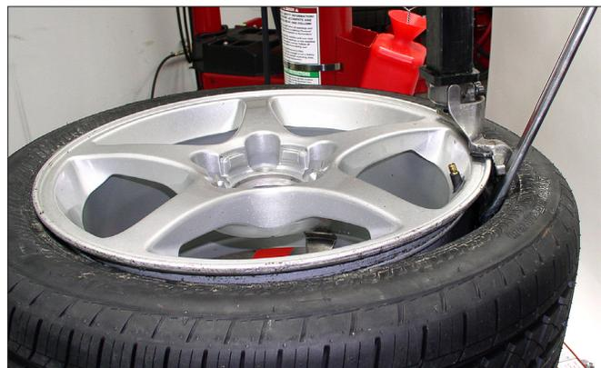
Figure 10 – Insérer l'outil de levage du talon
