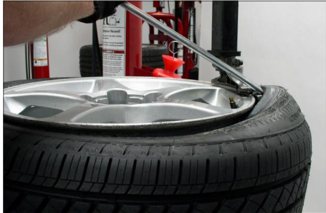
Figure 16 – Soulever le talon par-dessus l'outil de démontage
