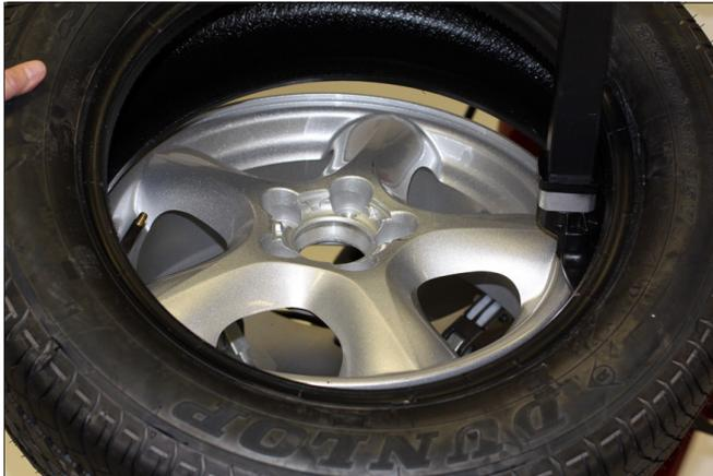
Figure 21 - Positionner le pneu contre l'outil de montage Duckhead®
