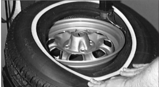
Figure 22 - Montage du talon supérieur
