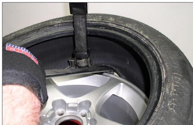
Figure 13 – Guider le talon par-dessus la tête de l'outil
