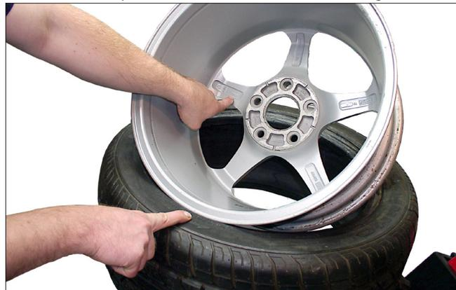
Figure 18 - Vérifier la concordance des dimensions entre le pneu et la roue
