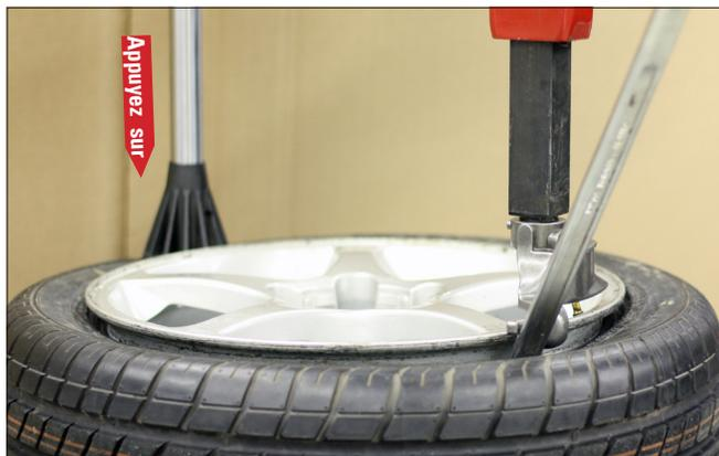
Figure 15 – Insérer l'outil de levage du talon
