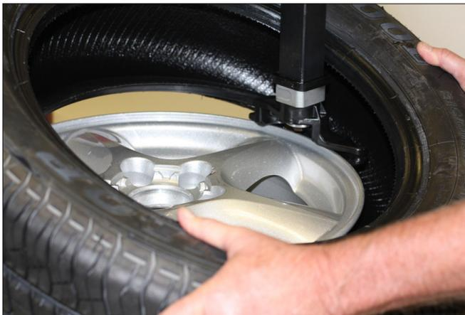
Figure 22 - Montage du talon inférieur
