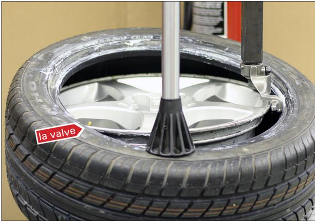
Figure 23 - Montage du talon avec le Robo-Arm LR
