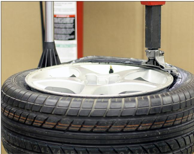
Figure 24 - Utiliser le bas du Robo-Arm LR pour retourner le talon par-dessus la bride de jante
