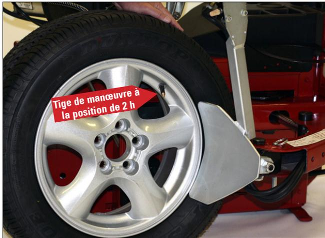
Figure 3 - Positionner le pneu et le sabot de desserrage du talon avec la tige de manœuvre à la position de 2h.
