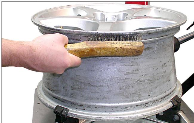
Figure 19 - Inspecter et nettoyer la roue
