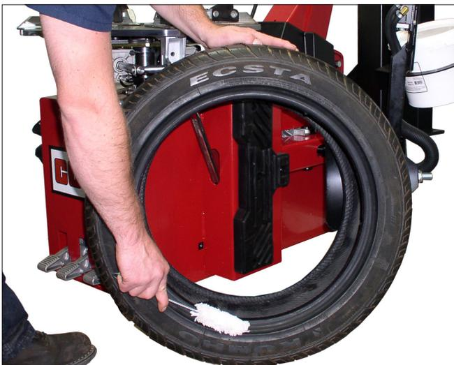
Figure 20 - Lubrifier abondamment les talons de pneu
