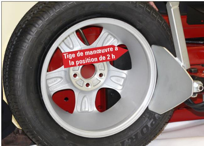
Figure 4 - Positionner le pneu et le sabot de desserrage du talon avec la roue retournée et la tige de manœuvre à la position de 2 h.
