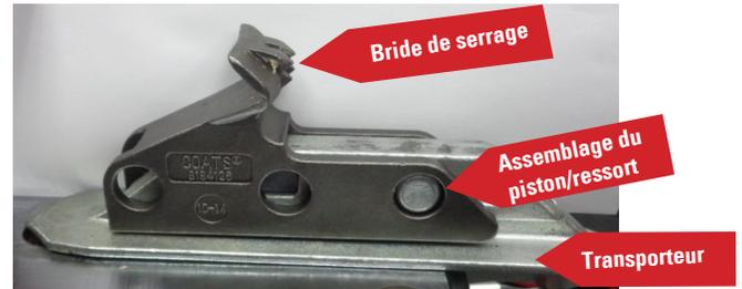
**Remarque:** Pour retirer la bride de serrage du transporteur, appuyer sur assemblage du piston/ressort et sur la goupille de retenue en même temps. Faire glisser la bride de serrage hors du transporteur.
