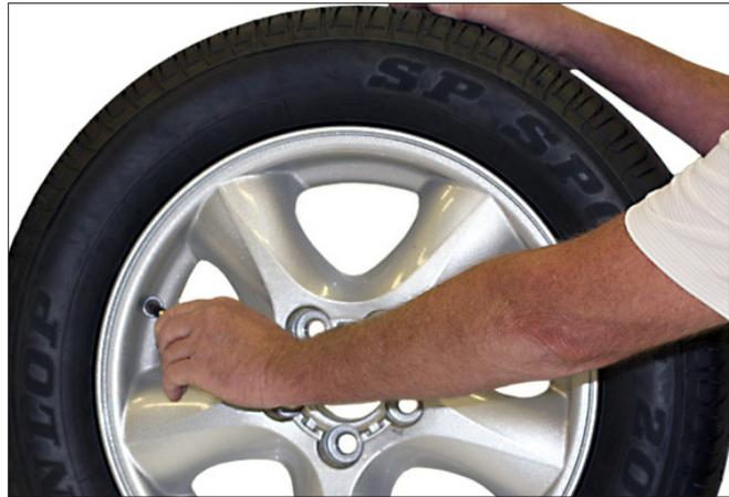
Figure 1 – Retirer l'obus de valve pour dégonfler le pneu
