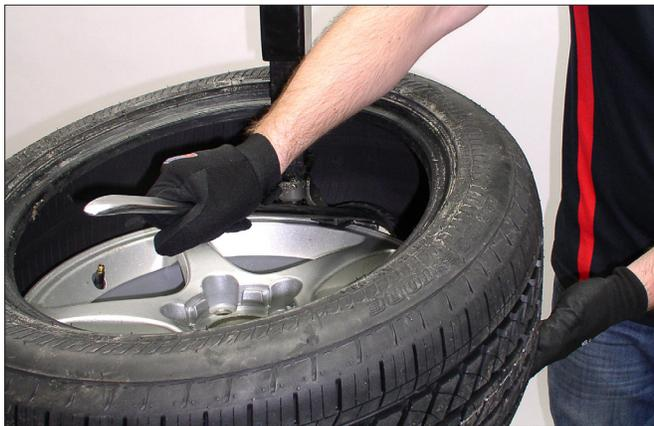
Figure 12 – Démontage du talon inférieur
