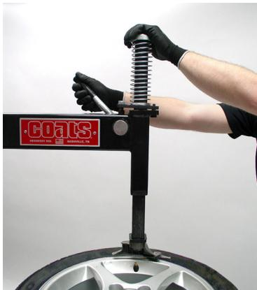
Figure 7 – Positionner l'outil de montage/démontage
