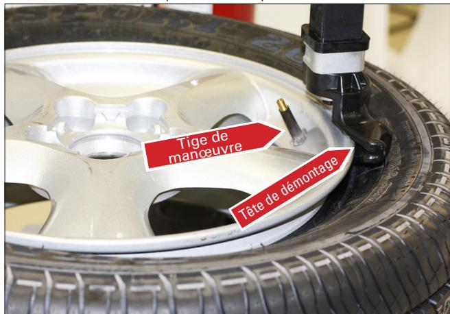
Figure 17 – Positionner la tige de manœuvre sous la tête de démontage
