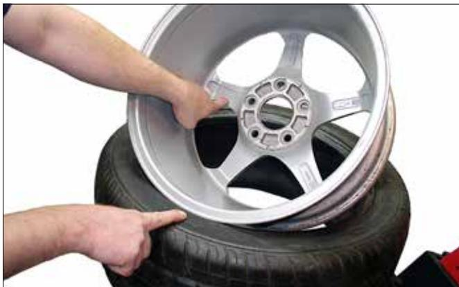
Figure 16 – Vérifier la concordance des dimensions entre le pneu et la roue
