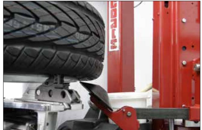
Figure 14 – Le disque d'assistance facilite le démontage du talon inférieur
