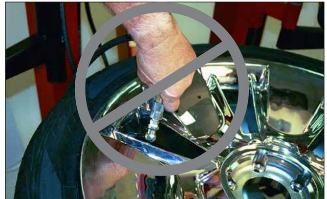
Figure 27 – Ne pas utiliser un mandrin d'air de style portatif
