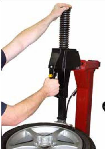
Une fois la tour penchée en avant, appuyer sur le bouton de la valve de blocage de la coulisse pour permettre à l'outil de montage/démontage de descendre sur la paroi latérale du pneu (figure 9). Ensuite, déplacer l'outil de montage/démontage vers la jante et lâcher le bouton de blocage.
