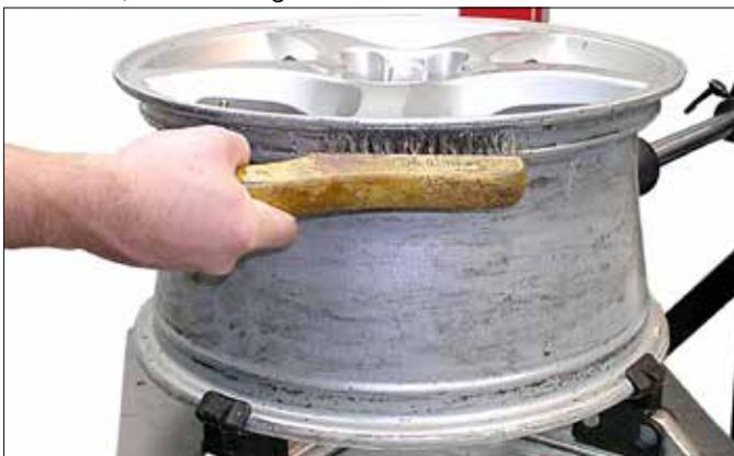
Figure 17 – Inspecter et nettoyer la roue
