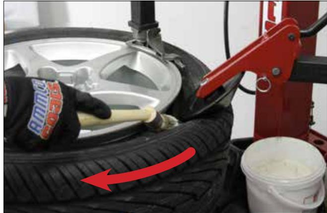
*Figure 10 – Appliquer du lubrifiant de caoutchouc aux talons*
