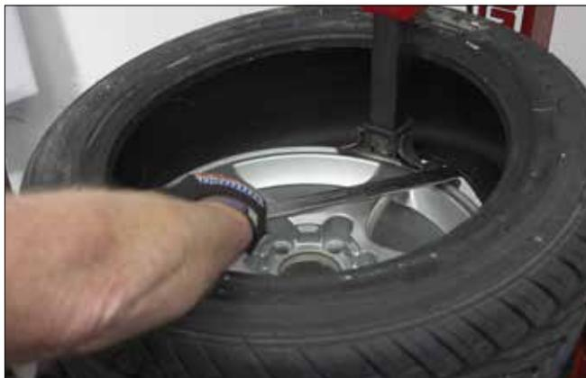
Figure 13 – Guider le talon inférieur par-dessus le bouton situé sur l'outil de démontage
