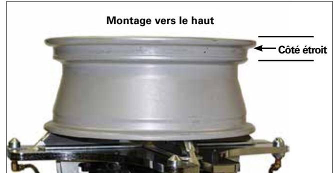
Figure 6 – Placer l'ensemble de pneu/roue sur l'établi
