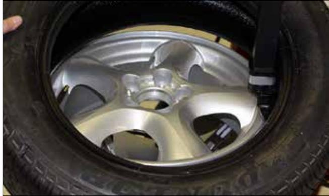
Figure 19 – Positionner le pneu contre l'outil de montage/démontage
