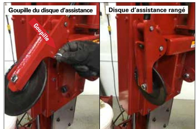
Figure 15 – Ranger le disque d'assistance
