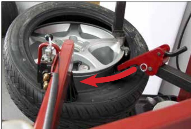
Figure 21 – Maintenir le talon du pneu dans la jante creuse
