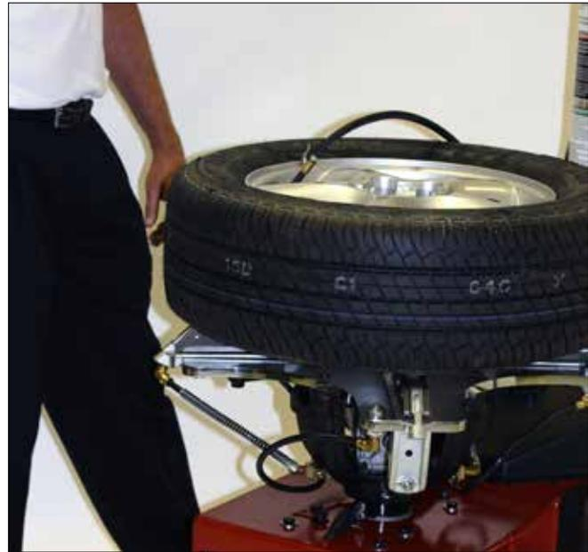
Figure 25 – Se reculer durant la mise en place du talon
