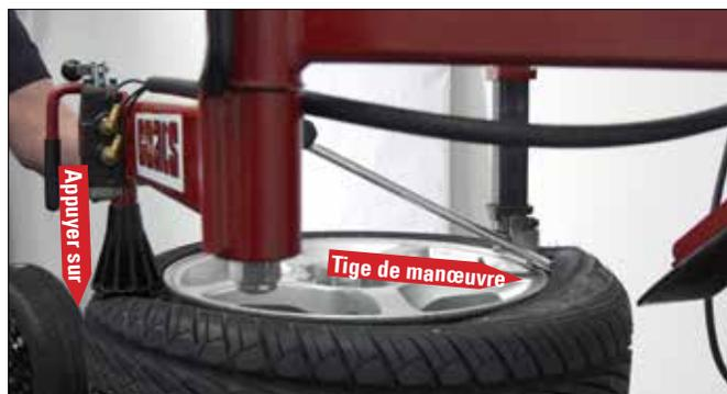
*Figure 11 – Insérer l'outil de levage du talon*
