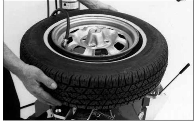
*Figure 24 – Soulever le pneu en le plaçant à la verticale pour le scellement du talon*
