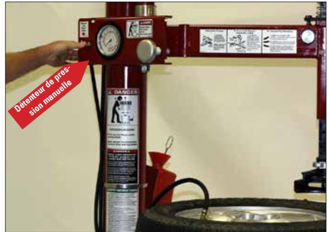
Figure 26 – Emplacement du détendeur de pression manuel
