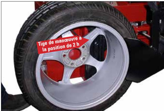
Figure 4 – Positionner le pneu et le sabot de desserrage du talon avec la roue retournée et la tige de manœuvre à la position de 2 h.
