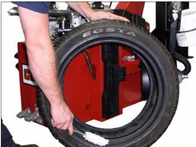
Figure 18 - Lubrifier abondamment les talons de pneu
