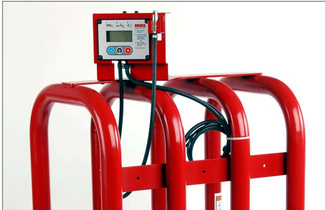
**8.** Connecter l'entrée d'air à l'entrée de la cage et l'entrée de la cage au changeur. Ouvrir l'alimentation en air et connecter la prise électrique à un courant de 110 V.
