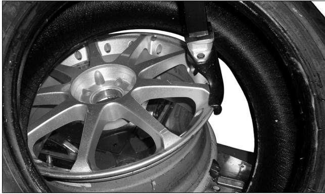
Figure 18 - Positionnez le pneu contre le Duckhead®
