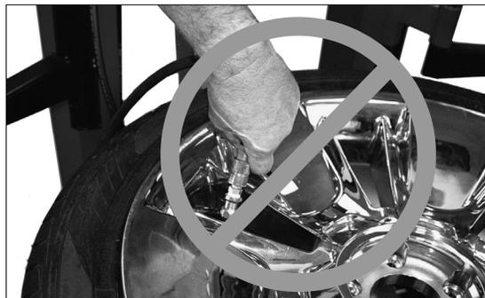
Figure 26 - N' utilisez pas de mandrin à air de style manuel
