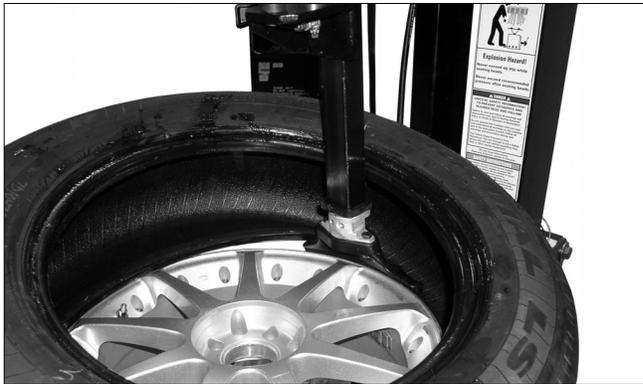
Figure 19 - Montage du talon inférieur
