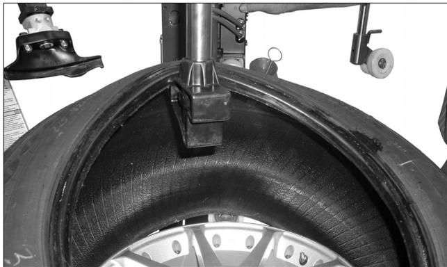
Figure 13 - Levez le pneu pour retirer le talon inférieur
