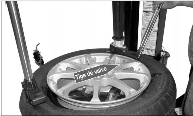
Figure 11 - Insérez l'outil de levage du talon
