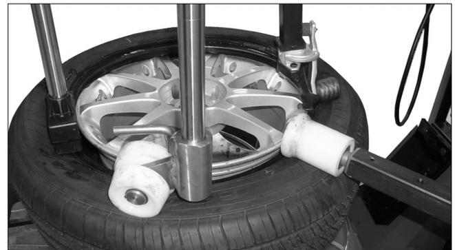
Fig 22 - Utilisez le RoboRoller (si présent) pour maintenir le pneu dans le creux de la jante.
