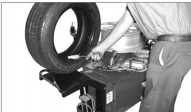
Figure 17 - Lubrifiez les talons du pneu
