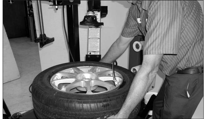
Figure 23 - Levez le pneu pour le joint du talon
