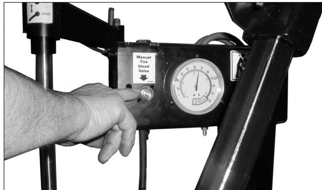
Figure 25 - Emplacement de la valve de libération manuelle
