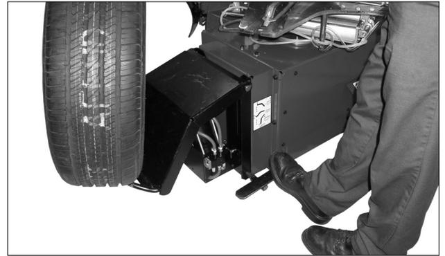
Figure 5 - Levez la roue sur l' établi
