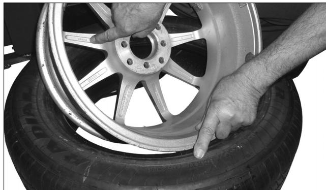
Figure 15 - Vérifiez la correspondance de dimension entre le pneu et la roue
