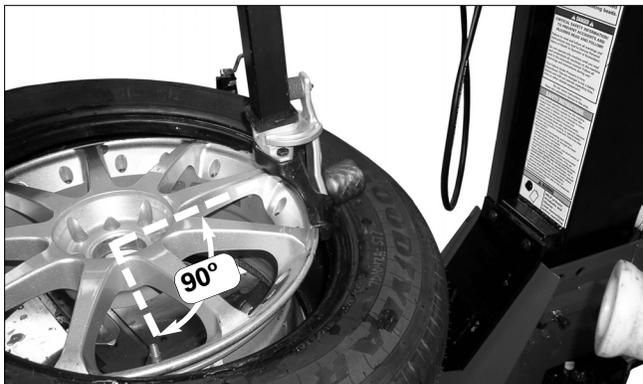
Figure 20 - positionnez la tige de la valve à 90° en avant du Duckhead
