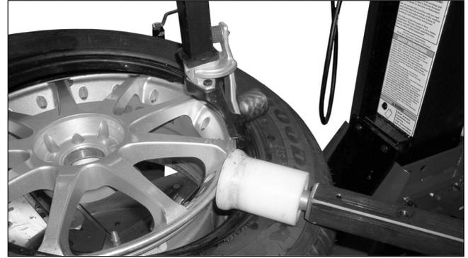
Figure 21A - Utilisez la roulette puissante pour maintenir le pneu dans l'alignement du creux de la jante
