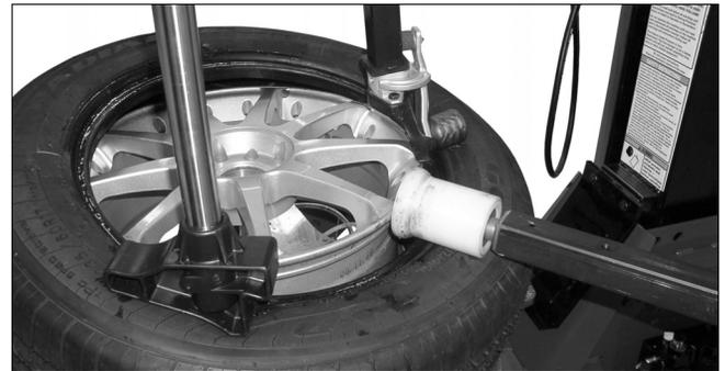
Fig 21B - Utilisez le RoboArm pour maintenir le pneu dans le creux de la jante.
