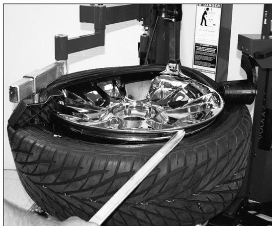
Figure 42 – Au besoin, utiliser l'outil à soulever
