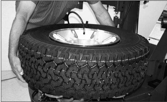
Figure 20 – Le pneu est soulevé pour faciliter le scellement du talon
