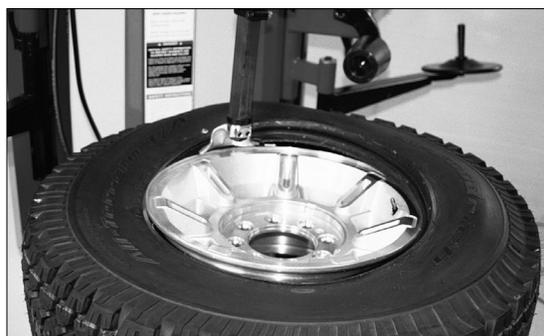
Figure 11 - Démontage du talon supérieur
