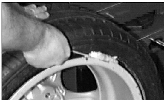
Figure 29 – Lubrification du talon inférieur
