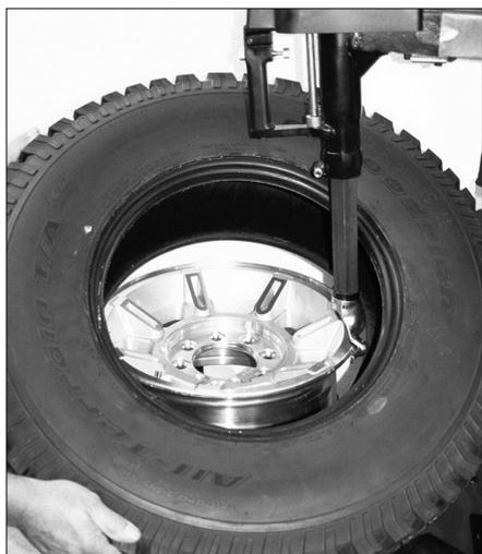
Figure 17 – Placer le pneu contre la tête de canard Duckhead®
