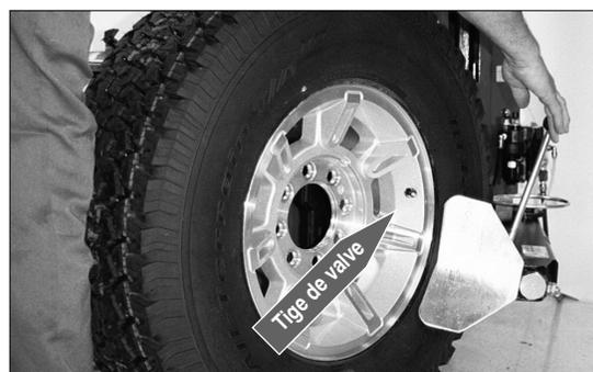
Figure 3 – Mise en place du pneu et du sabot de desserrage de talons
