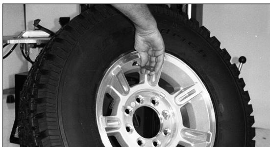
Figure 1 – Retrait de l'obus de valve pour dégonfler le pneu
