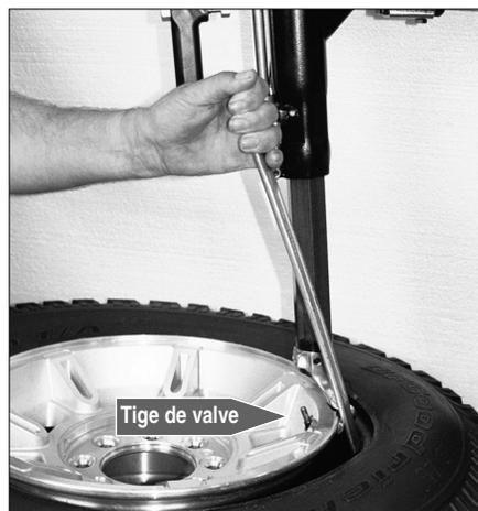
Figure 10 – Insertion de l'outil servant à soulever le talon
