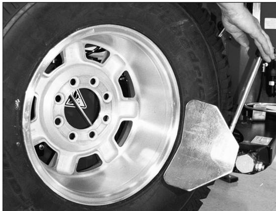
Figure 4 – Mise en place du pneu et du sabot de desserrage de talons (la roue étant tournée)
