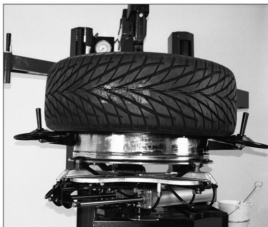
Figure 36 – Soulever le talon inférieur jusqu'à la hauteur de la jante creuse de la roue
