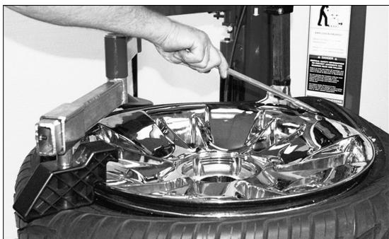
Figure 34 – Le talon est soigneusement monté sur la tête de canard Duckhead®
