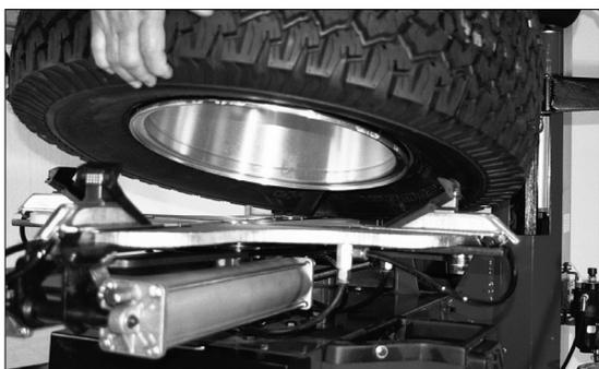
Figure 5 – Étrier fixé à l'extérieur d'une roue en magnésium
