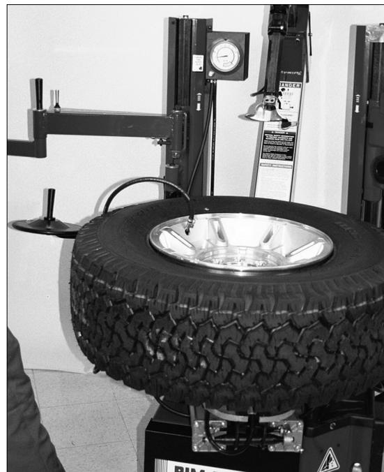
Figure 21 – S'éloigner du changeur de pneus durant la mise en place des talons
