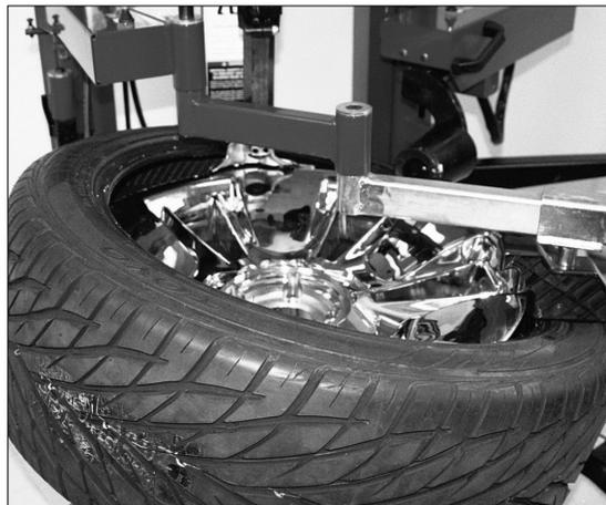
Figure 40 – Mise en place des outils d'appoint de gauche et de droite
