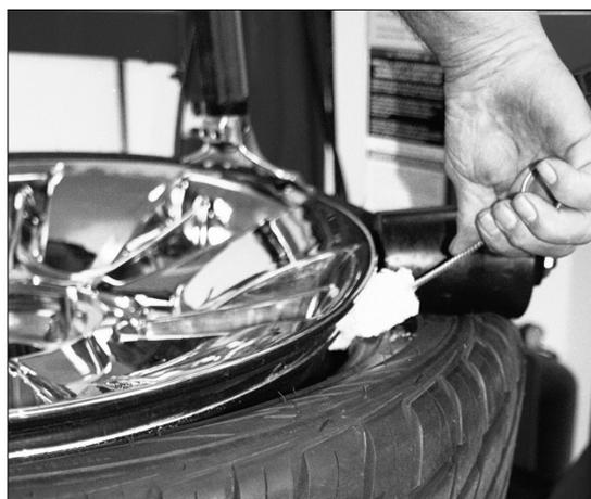
Figure 32 – Lubrification du talon supérieur
