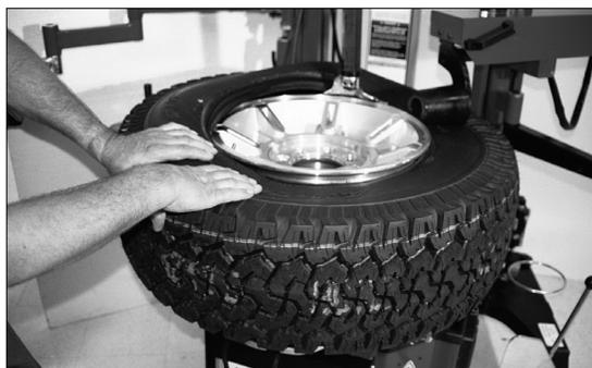
Figure 19 – Montage du talon supérieur
