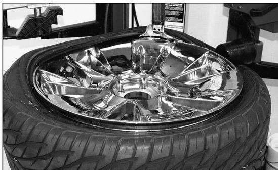
Figure 43 – L'outil d'appoint de gauche doit suivre le verrou du talon
