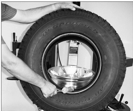
Figure 16 – Enduire les talons d'une quantité généreuse de lubrifiant
