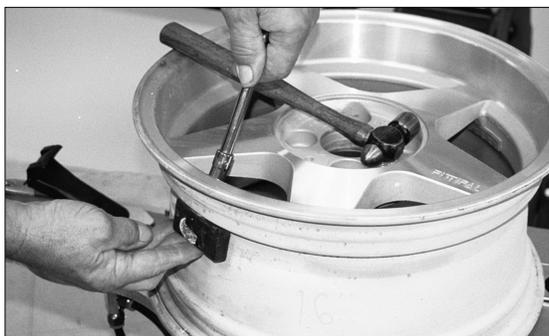
Figure 24 – Jante dotée d'un potentiomètre (le pneu est retiré pour une plus grande clarté des détails)
