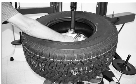
Figure 37 – Démontez le talon inférieur de la jante
