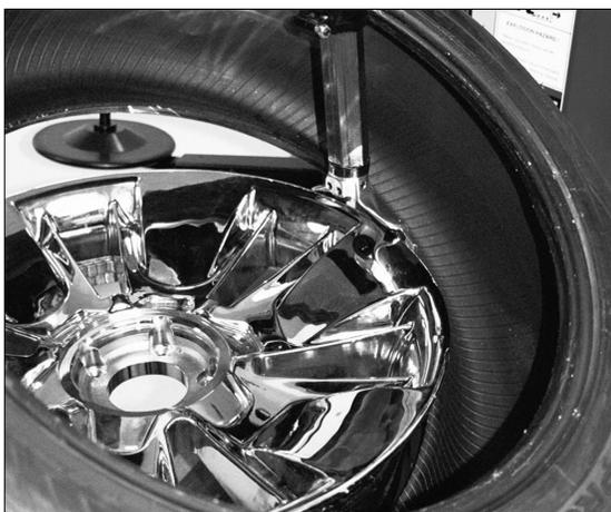
Figure 39 - Montage du talon inférieur
