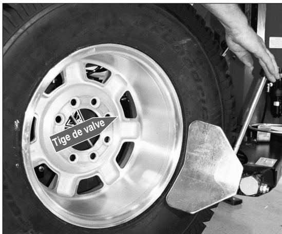
Figure 28 – Desserrage du talon inférieur
