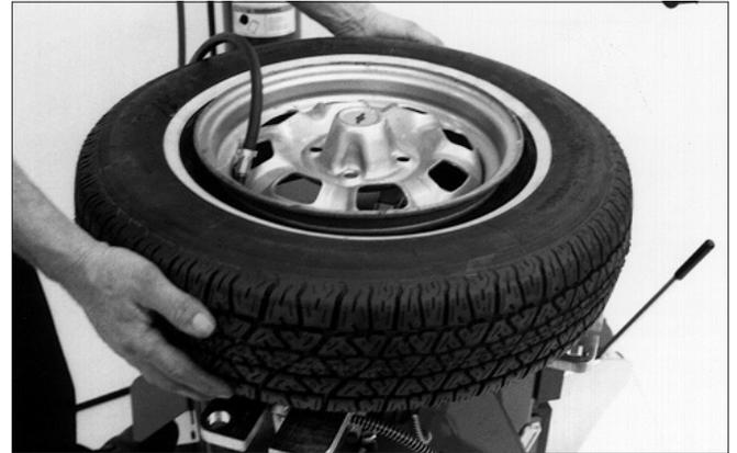
*figure 25 – Soulever le pneu en le plaçant à la verticale pour le scellement du talon*
