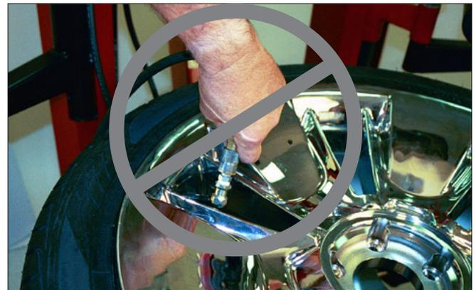
figure 28 - Ne pas utiliser un mandrin d'air de style portatif
