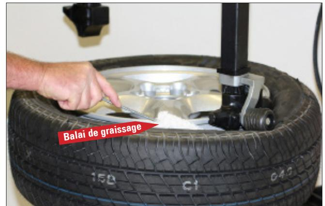
figure 35 - Lubrifier le talon supérieur
