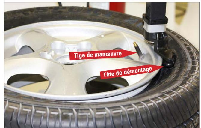
figure 36 - Positionner la tige de manœuvre sous l'outil de démontage
