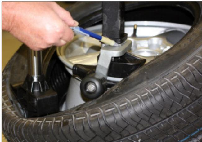
figure 44 - Galet Duckhead bien monté sur le support
