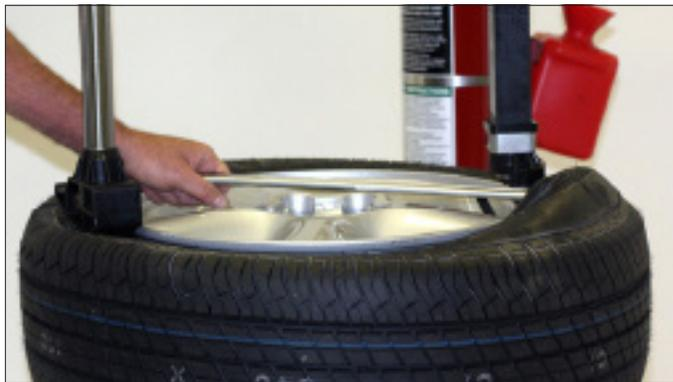
figure 13 – Soulever le talon par-dessus l’outil de démontage
