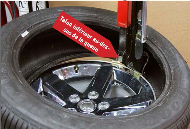
figure 58 - Positionner le pneu contre l'outil de levage du talon
