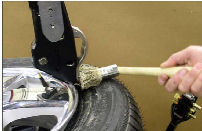
figure 49 - Appliquer du lubrifiant sur le crochet de l'outil de levage de talon
