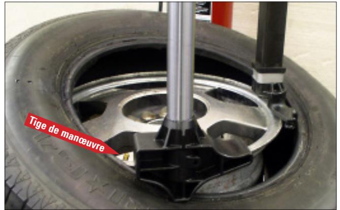
Fig 45 - Utiliser le Robo Arm (bras mobile) pour retenir le pneu dans la jante creuse
