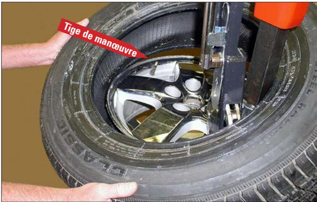
figure 57 - Positionner la tige de manœuvre en avant du verrou de talon
