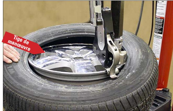
figure 59 - Positionner la tige de manœuvre en avant du verrou de talon
