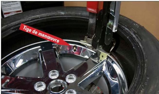
figure 53 - Outil de levage sans levier accroché sous le talon inférieur du pneu
