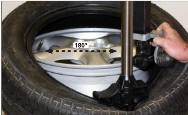
figure 43 - Positionner la tige de manœuvre à 180 degrés en avant de l'outil de montage/démontage
