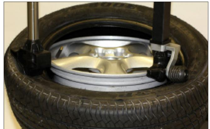
figure 46 - Montage du talon supérieur
