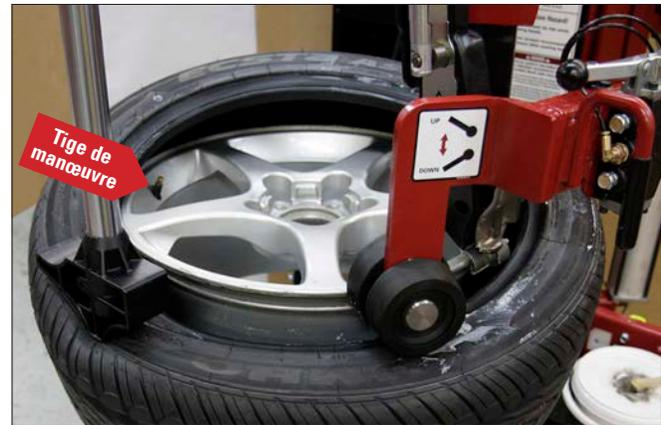
figure 60 - Robo-Arm et Robo-Roller poussant le talon du pneu dans la jante creuse
