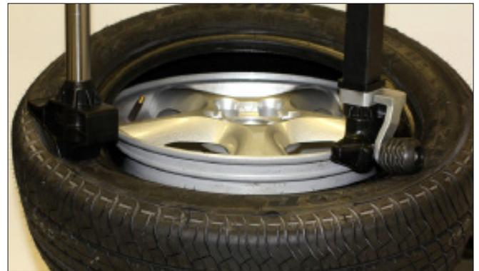
figure 24 - Montage du talon supérieur
