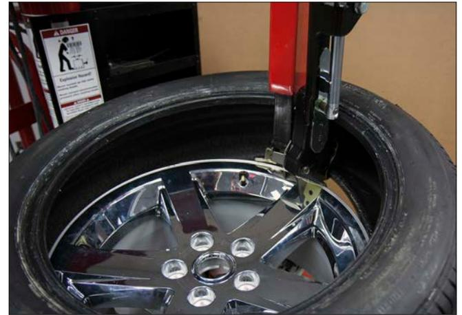
figure 55 – Démontage du talon inférieur du pneu
