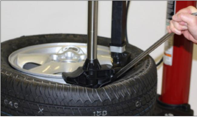
figure 37 – Insérer l’outil de levage du talon
