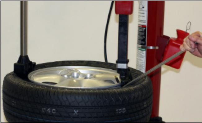
figure 38 - Pied auxiliaire poussant le talon dans la jante creuse
