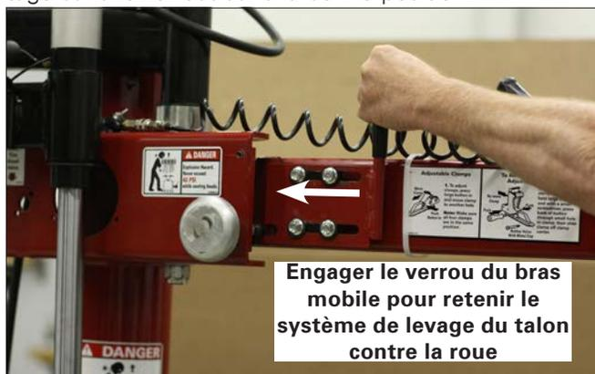
figure 48 - Bloquer le bras mobile en position
