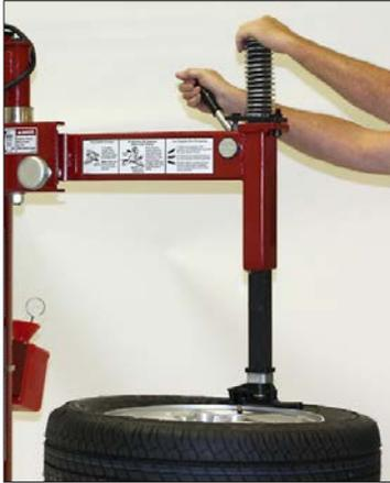
Appuyer sur le dessus de la coulisse verticale pour déplacer la tête de démontage afin qu'elle touche le bord de la jante. Pousser la poignée de blocage en arrière afin de bloquer la coulisse en place. Une fois que la coulisse est bloquée, l'outil de montage/démontage se déplacera vers le haut à environ 1/8 pouce du bord de la jante (figure 8).
