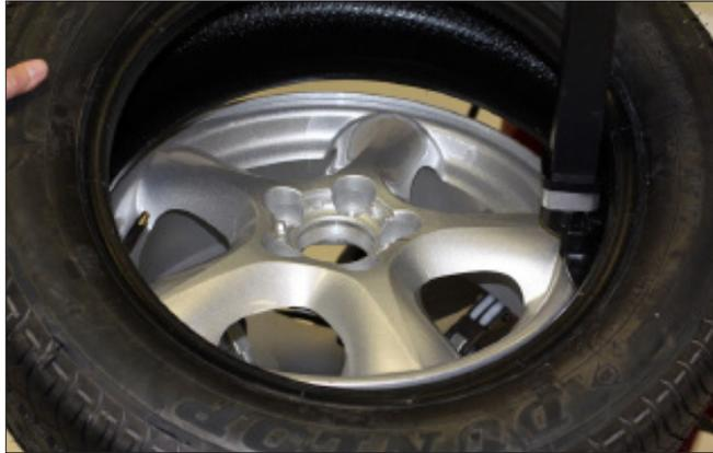
figure 19 - Positionner le pneu contre l'outil de montage/démontage
