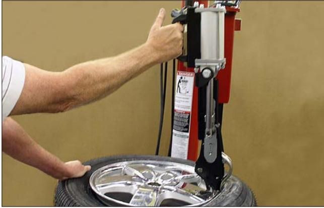
figure 51 - Outil sans levier accroché sous le talon du pneu
