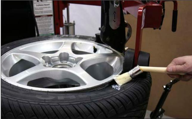
figure 56 - Utiliser le Robo-Roller lors de l'application de lubrifiant au talon du pneu
