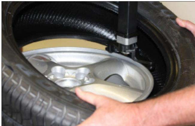
figure 20 - Montage du talon inférieur
