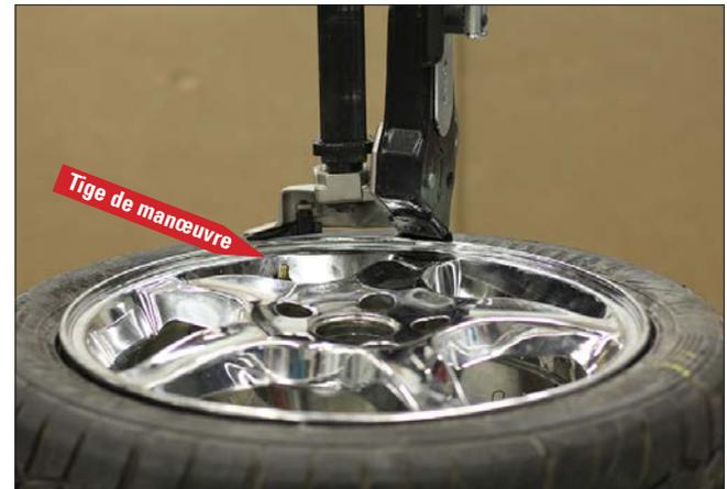
figure 50 – Positionner la tige de manœuvre derrière l'outil de démontage
