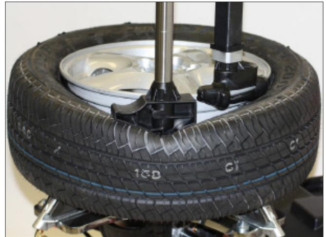
figure 34 - Pied auxiliaire pour exercer une pression sur la paroi latérale du pneu
