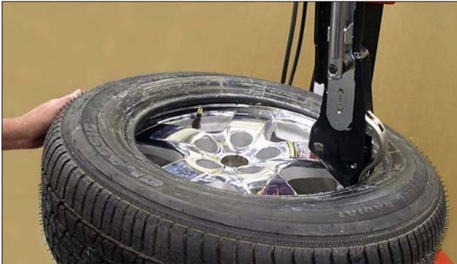
figure 52 – Démontage du talon supérieur du pneu
