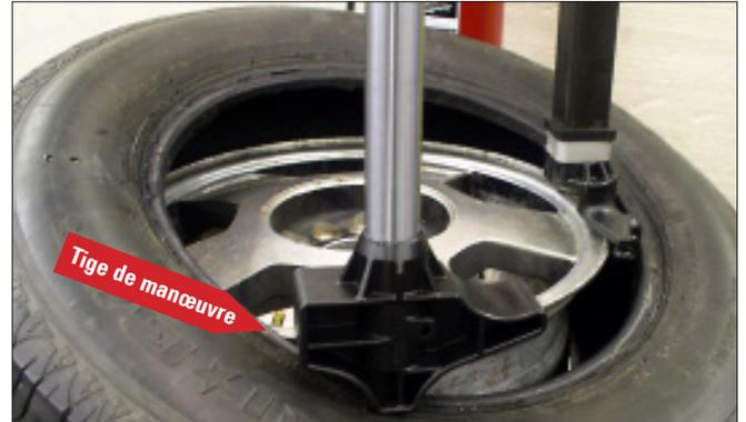
Fig 23 - Utiliser le Robo Arm (bras mobile) pour retenir le pneu dans la jante creuse
