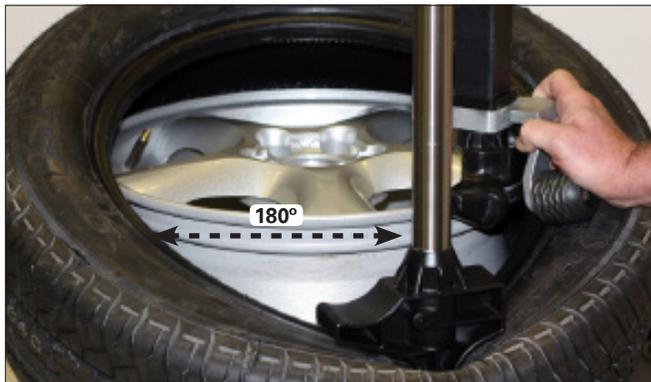
figure 21 - Positionner la tige de manoeuvre à 180 degrés en avant de l'outil de montage
