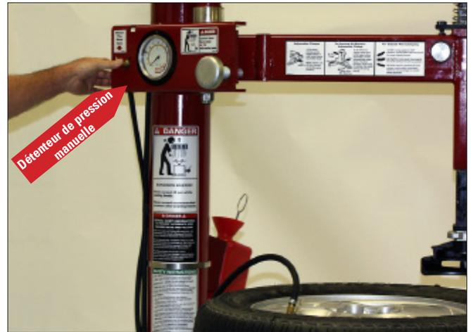
figure 27 - Emplacement du détendeur de pression manuel
