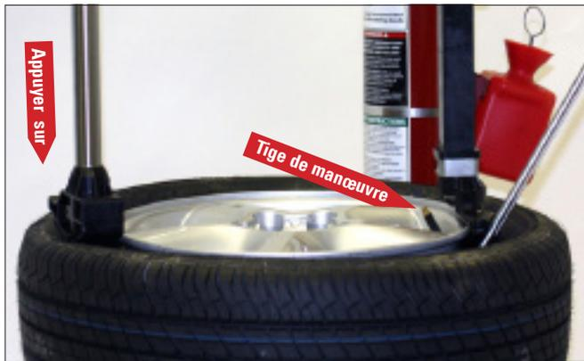
figure 12 – Insérer l’outil de levage du talon
