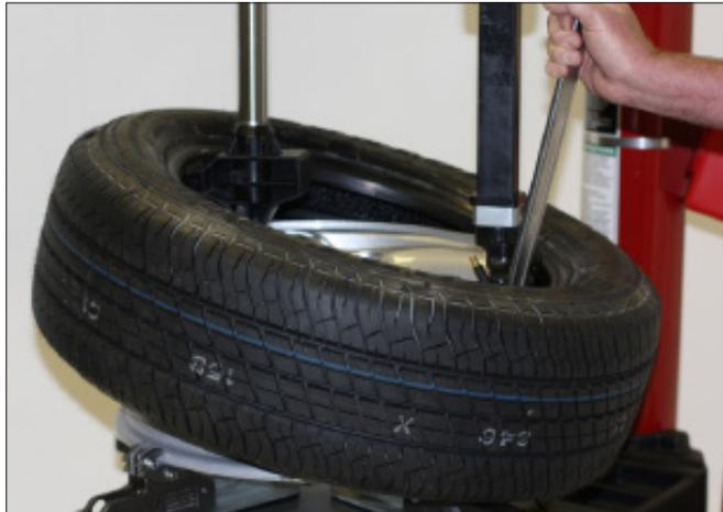
figure 42 - Pied auxiliaire retenant le talon inférieur dans la jante creuse
