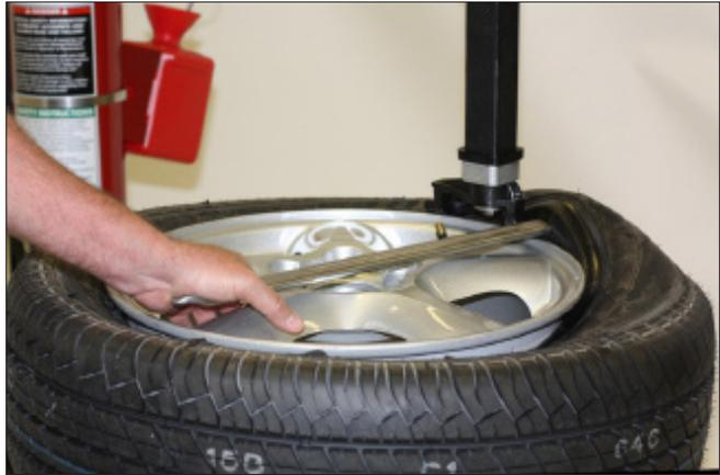
figure 40 - Tourner l’outil de levage vers le bas pour le démontage
