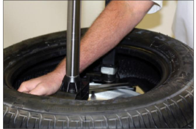
figure 15 – Guider le talon inférieur par-dessus l’outil de démontage
