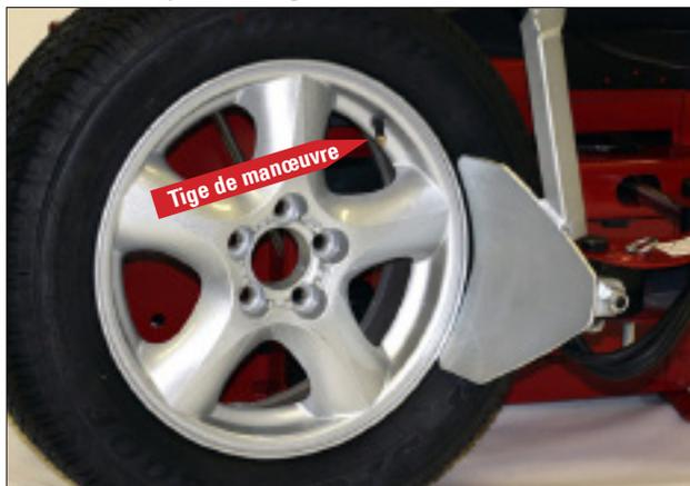
figure 29 - Positionner le pneu pour le desserrage du talon
