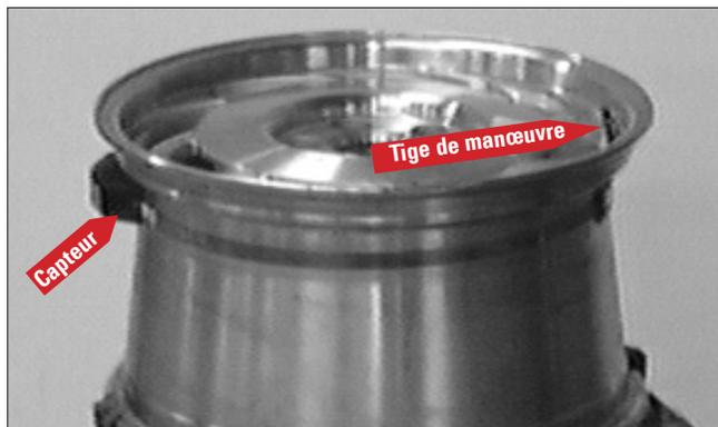
figure 31 - Roue avec capteur/transmetteur de faible pression
