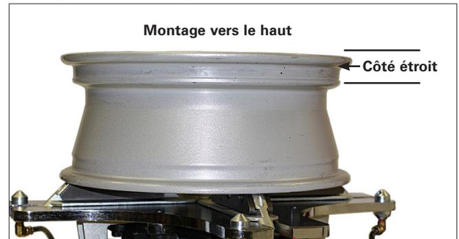
Figure 6 - Placer l'ensemble pneu et roue sur l'établi
