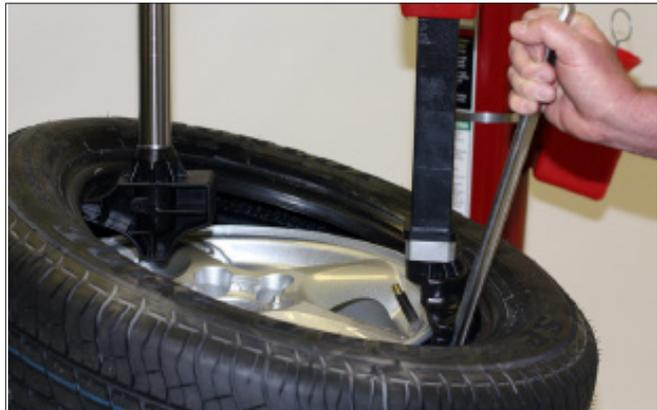
figure 41 - Tourner l’outil de levage vers le bas pour le démontage
