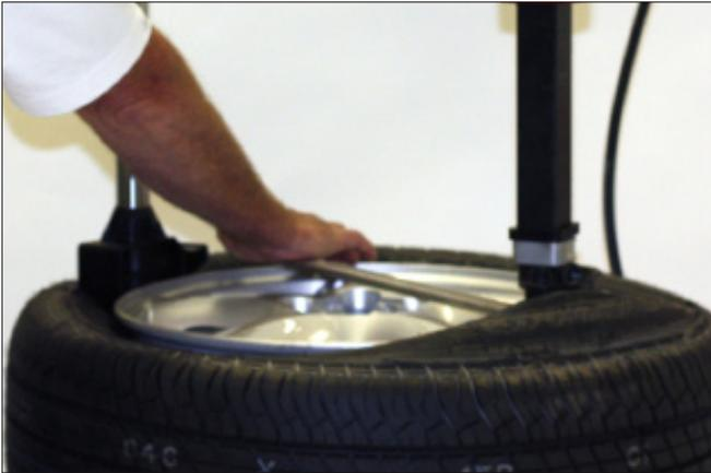
figure 39 - Tourner l’outil de levage vers le bas pour le démontage
