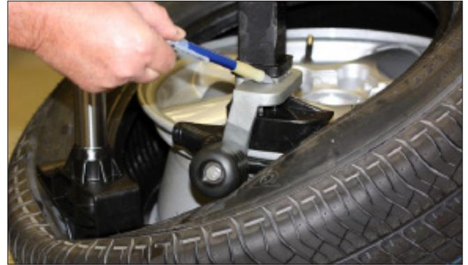
figure 22 - Galet Duckhead bien monté sur le support
