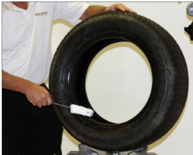
figure 18 - Lubrifier abondamment les talons de pneu
