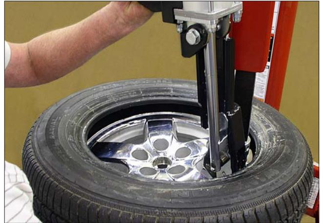
figure 54 - Pousser la poignée de commande vers le haut pour soulever le talon au-dessus de la jante
