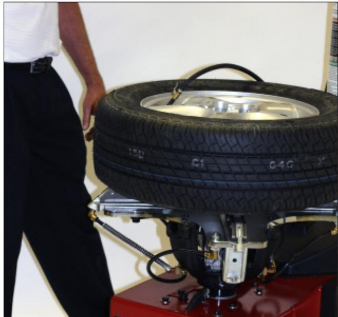
figure 26 – Reculer votre corps durant la mise en place du talon
