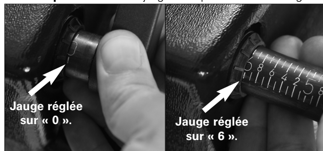
Figure 48 - Étalonnage de l'écartomètre
