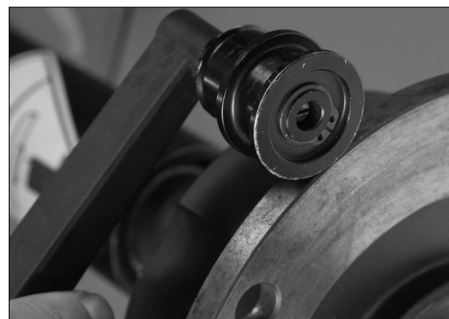
Figure 49A - Positionnement de la jauge du bras de départ en plastique sur le plateau de montage
