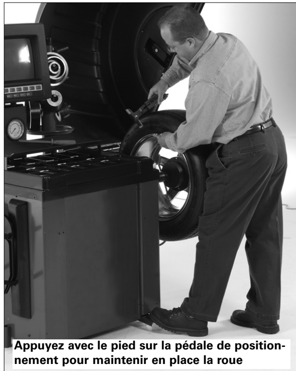
Figure 5 - Pédale de positionnement
