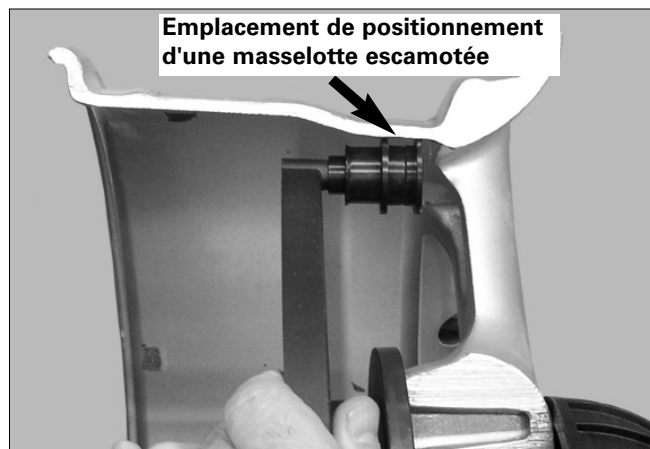
Figure 8 - Emplacement d'une masselotte adaptable - Jante illustrée en coupe transversale pour une plus grande clarté des détails.
