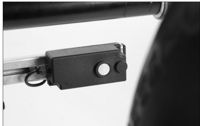
Figure 12 - Détecteur de faux rond radial
