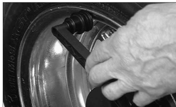
Figure 52 - Étalonnage du bras de diamètre (en plastique)
