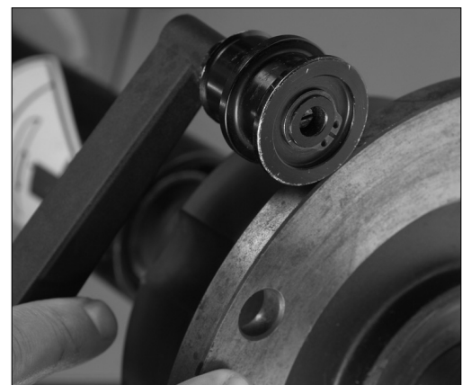
Figure 40 - Positionnement de la jauge du bras de déport sur le plateau de montage
