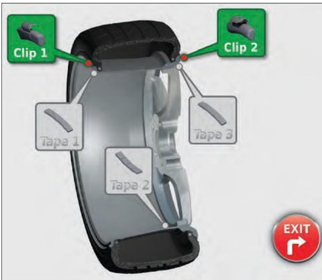
Figure 19 – Icônes Direct Select MC pour les poids et le diagramme transversal de la roue
