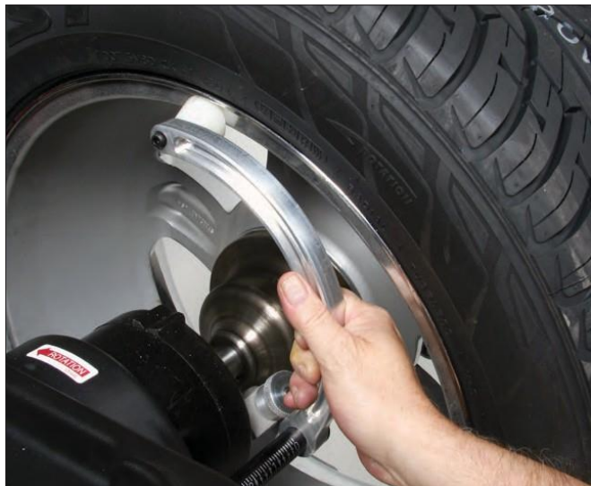
Figure 8A – Mesures automatiques A et D à l'emplacement des poids d'équilibrage à accrocher
