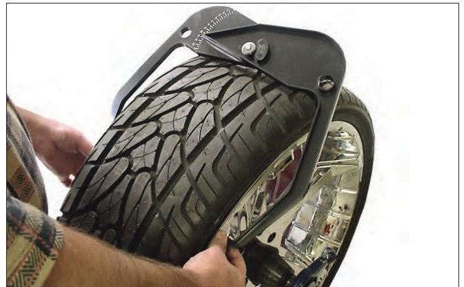
Figure 22 - Placement de l'étrier sur la roue
