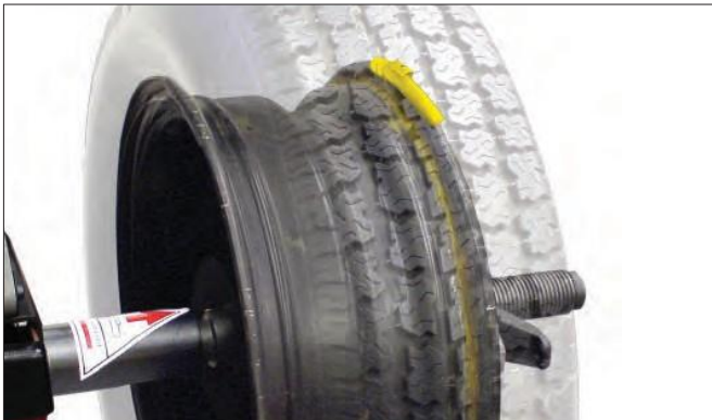
Figure 1 – Poids d'étalonnage sur le rebord interne, au point mort haut
