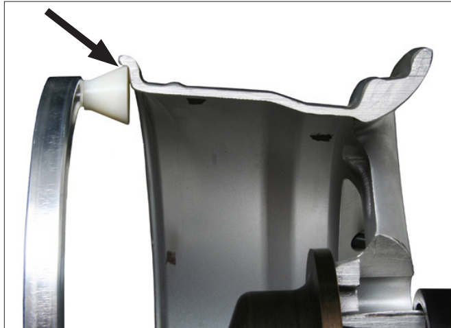
Figure 11 - Vue de l'emplacement des masses d'équilibrage pincées sur une jante en coupe
