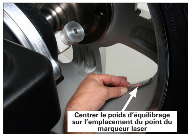
Figure 17 – Centrage du poids d'équilibrage caché sur l'emplacement du point laser.
