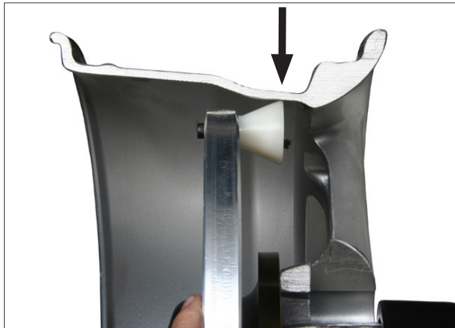
Figure 12 - Vue de l'emplacement des masses d'équilibrage pincées sur une jante en coupe.
