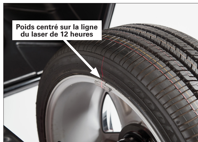
Figure 19 - Correction du poids de correction à 12 heures Localisation de la ligne laser
