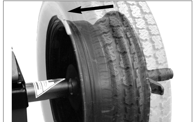
Image 21 - Déplacement du Poids de Calibration (Directement Parallèle) Au Flanc Intérieur
