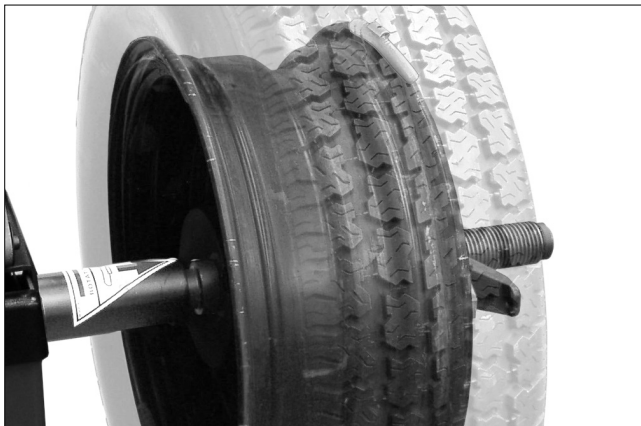
Image 20 - Poids de Calibration Sur Le Flanc Extérieur Au Point Mort Haut
