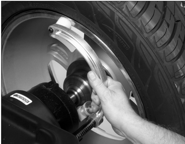
Image 6A - Mesure Automatique A&D à la Localisation des Poids Agrafés
