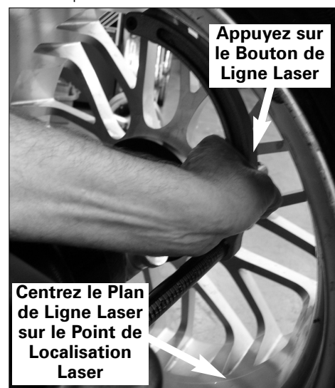
Image 9 - Positionnez le Plan de Ligne Laser à Localisation de Poids Cachés T2-Tape (A2)
