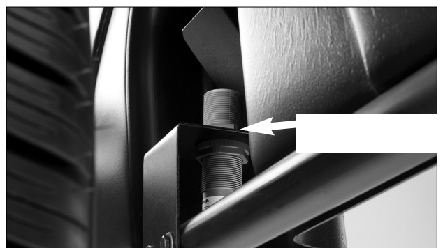
Image 10 - Capteur de Largeur de Pneu Localisé à l' intérieur du Capot
