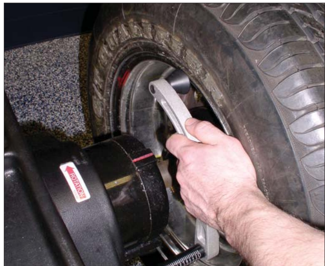
Figure 7 - Mesures automatiques A et D à l'emplacement des masses d'équilibrage pincées
