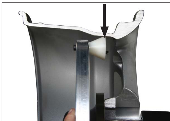
Figure 9 - Vue de l'emplacement des masses d'équilibrage cachées sur une jante en coupe
