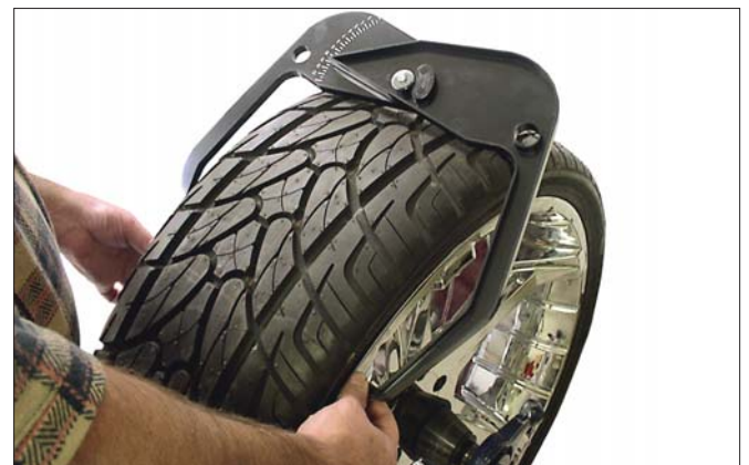
Figure 19 - Placement de l'étrier sur la roue
