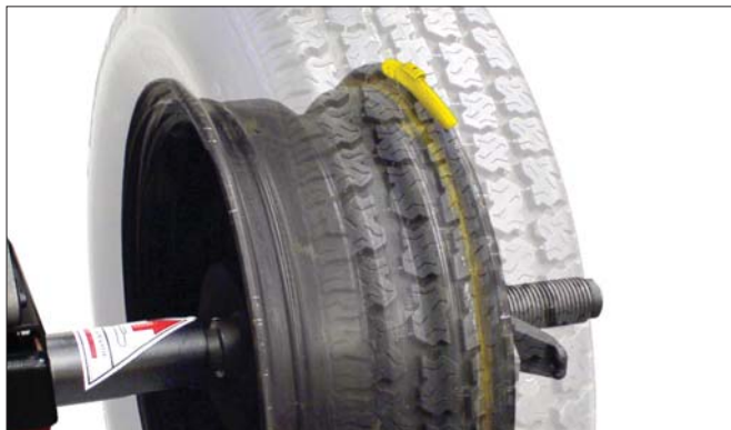
Figure 24 : Masse d'étalonnage sur le flan externe, au point mort supérieur.
