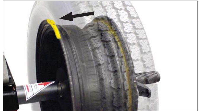
Figure 25 : Masse d'étalonnage sur le flan interne, au point mort supérieur
