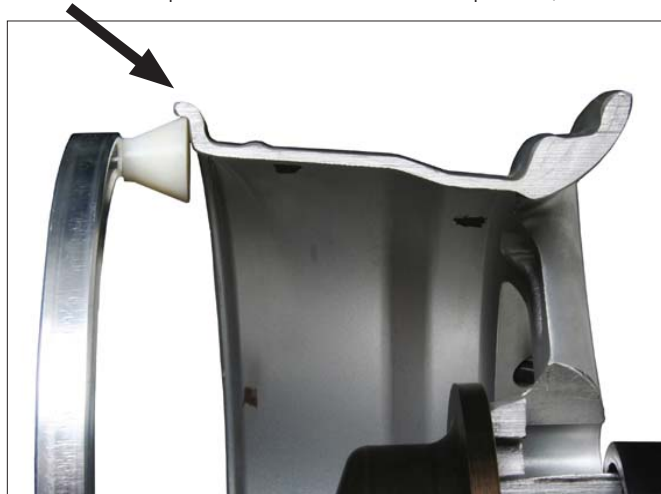
Figure 8 - Vue de l'emplacement des masses d'équilibrage pincées sur une jante en coupe
