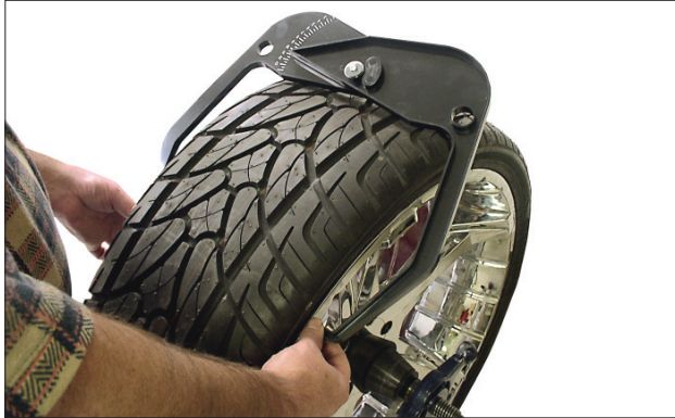
Figure 12 - Placement de l'étrier sur la roue
