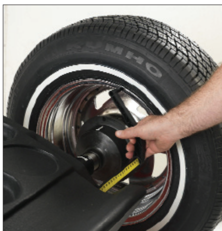
Figure 3 - Bras de mesure à l'emplacement des masses d'équilibrage pincées
