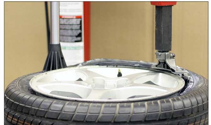
Figure 15 – Pied robotique retourne le talon par-dessus la joue de jante
