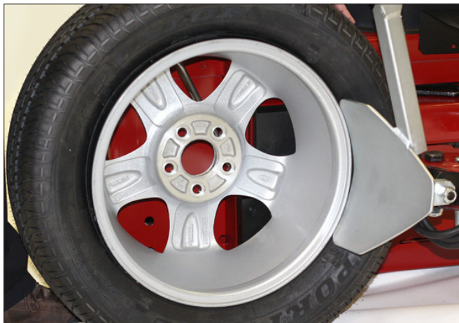
Figure 4 – Positionner le pneu et le sabot de desserrage pendant que la roue est retournée
