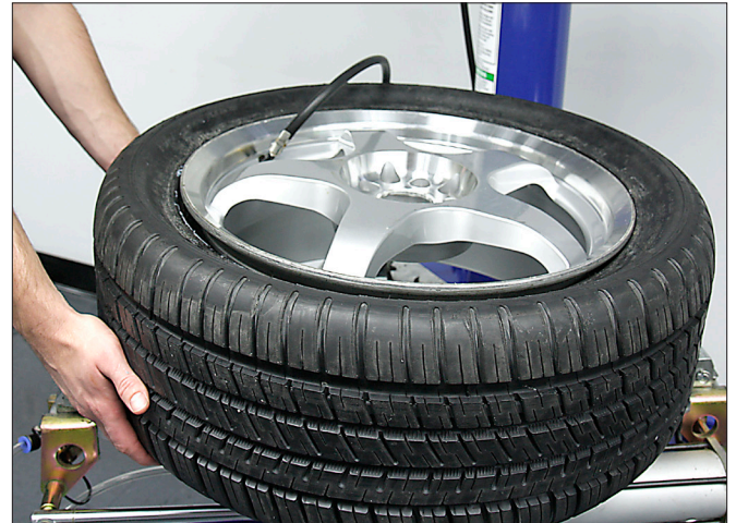
Figure 22 – Soulever le pneu en le plaçant à la verticale pour le scellement du talon
