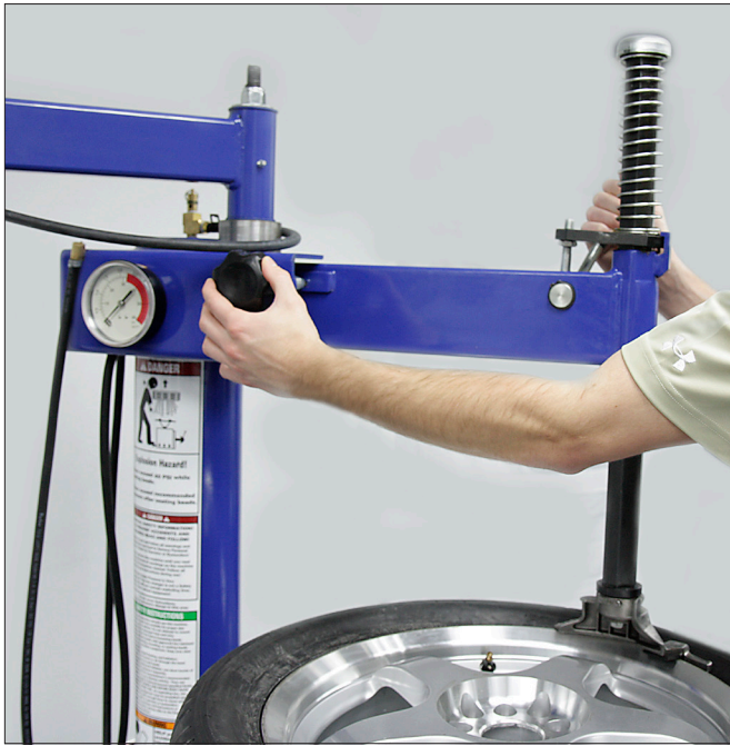
Figure 11 – Régler le bras mobile pour positionner le galet de tête
