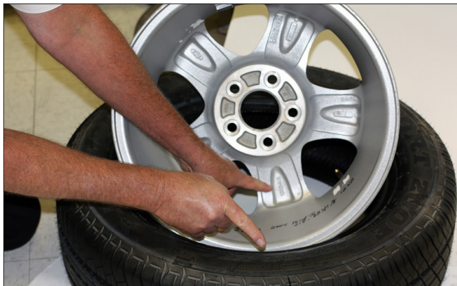
Figure 17 – Vérifier la concordance des dimensions entre le pneu et la roue
