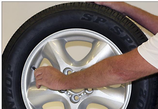
Figure 4 – Retirer l'obus de valve pour dégonfler le pneu
