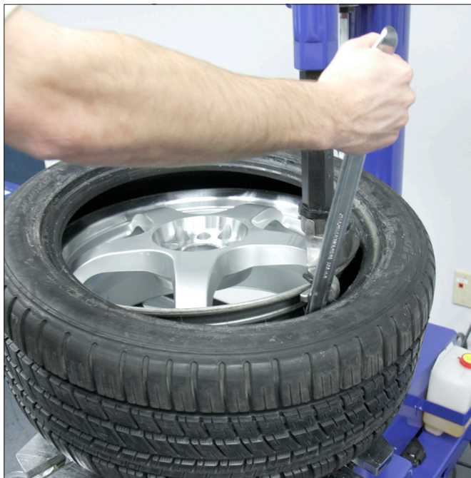
figure 15 – Démontage du talon inférieur
