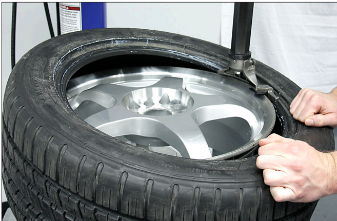
figure 21 – Montage du talon supérieur
