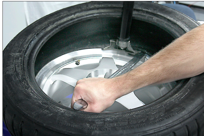
Figure 16 – Guider le talon inférieur par dessus le pommeau de l'outil
