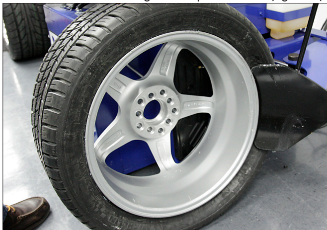
Figure 7 – Positionner le pneu et le sabot de desserrage pendant que la roue est retournée
