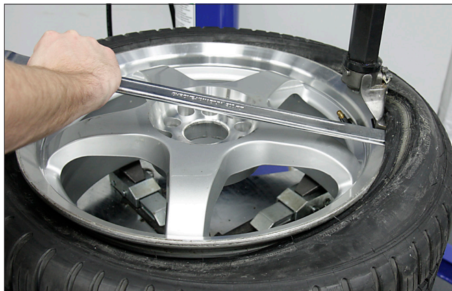
Figure 14 - Soulever le talon au-dessus du pommeau de l'outil de montage/démontage Duckhead®
