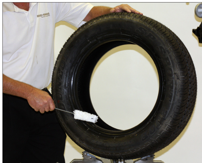
Figure 19 - Lubrifier abondamment les talons de pneu
