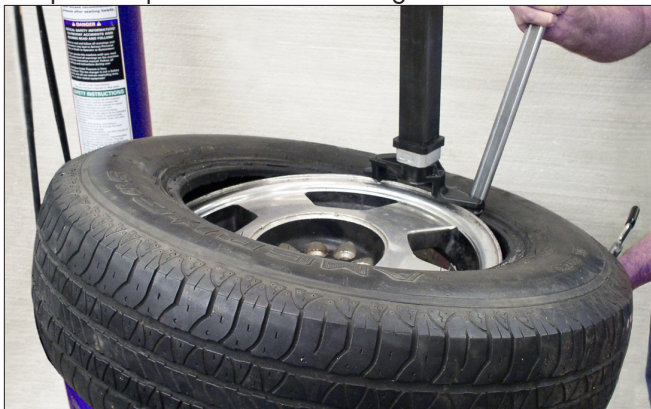
Figure 31 – Talon inférieur du pneu dans la jante creuse
