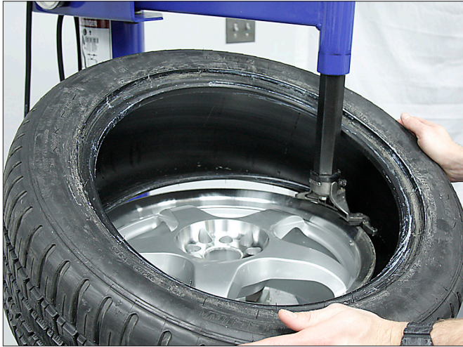
Figure 20 – Positionner le pneu contre l'outil de montage/démontage
