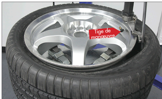
Figure 13 – Insérer l'outil de levage du talon sous le talon du pneu
