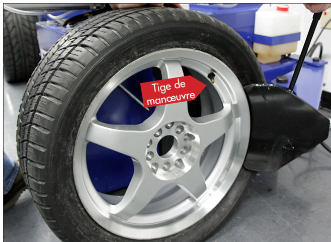
Figure 6 – Positionner le pneu et le sabot de desserrage
