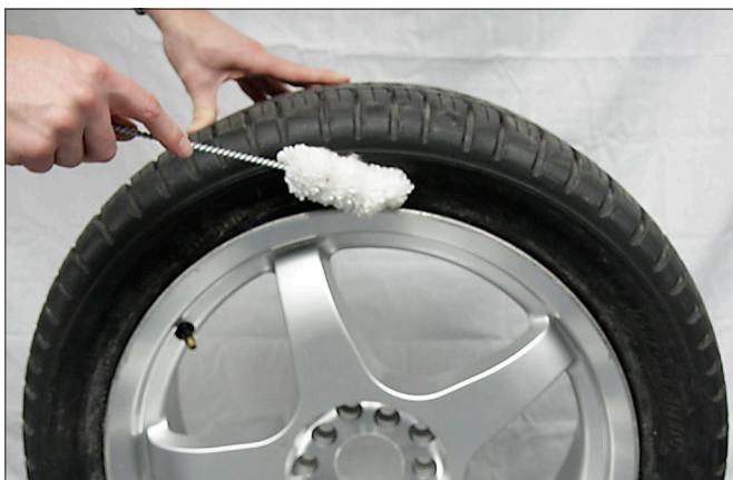
Figure 8 – Appliquer du lubrifiant de caoutchouc aux talons de pneu
