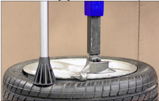
figure 25 - Pied auxiliaire pour exercer une pression sur la paroi latérale du pneu
