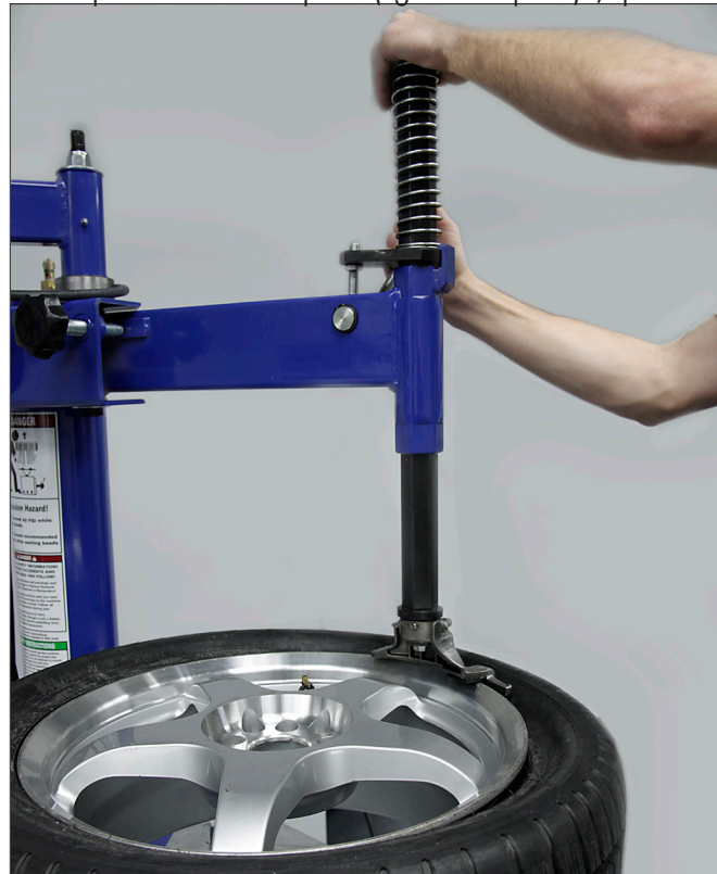
Figure 10 – Positionner l'outil de montage/démontage.
