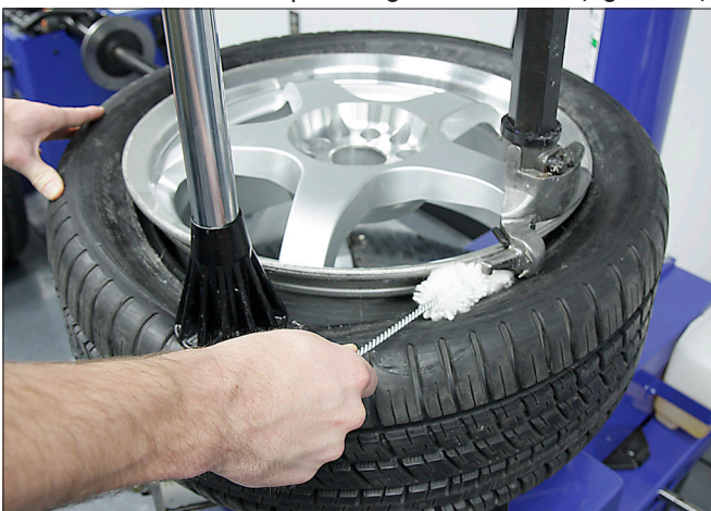
figure 26 – Lubrifier le talon supérieur
