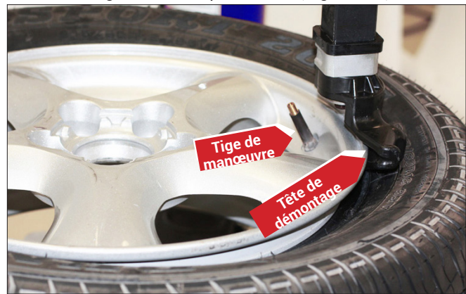
Figure 27 – Positionner la tige de manœuvre sous l'outil de montage/démontage
