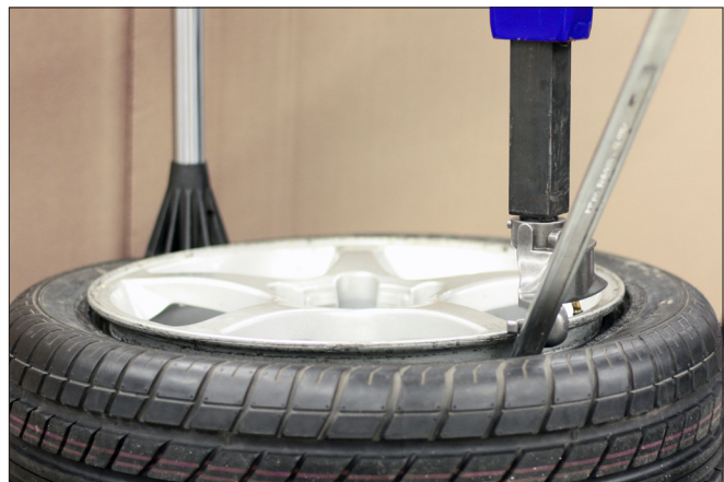
Figure 28 – Insérer l'outil de levage du talon
