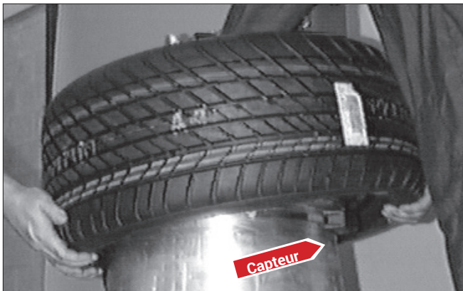
Figure 30 - Emplacement du capteur/transmetteur
