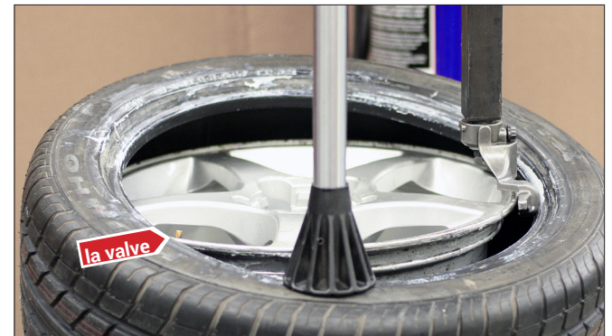
Figure 32 – Monter le talon supérieur du pneu, utiliser le bras robotique
