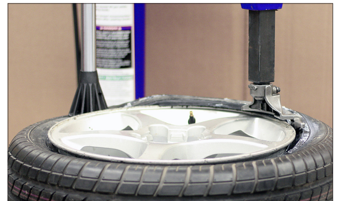
Figure 33 – Le pied auxiliaire retourne le talon par-dessus la joue de jante
