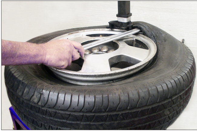
Figure 29 – Maintenir l'outil de levage en place et tourner la roue
