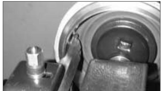
Figure 9 – Positionnement de la barre d'alésage
