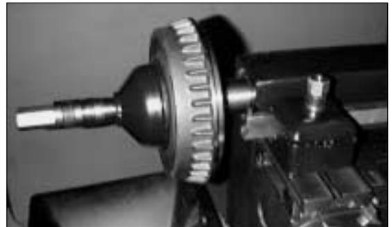
Figure 7 – Tambour et barre d'alésage montés sur le tour
