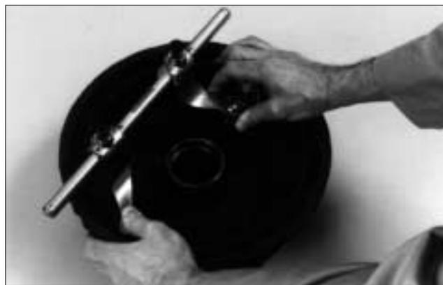
Figure 5 - Mesurage du diamètre du tambour
