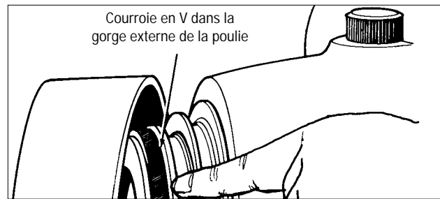
Figure 24 - Réglez l'emplacement de la courroie de transmission.
